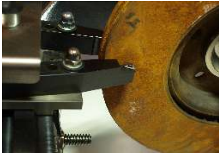
Bild 2: Der Schwingungsdämpfer bewegt sich wie abgebildet über den Schneidarmen. Der Schwingungsdämpfer sollte jedes Mal verwendet werden.
